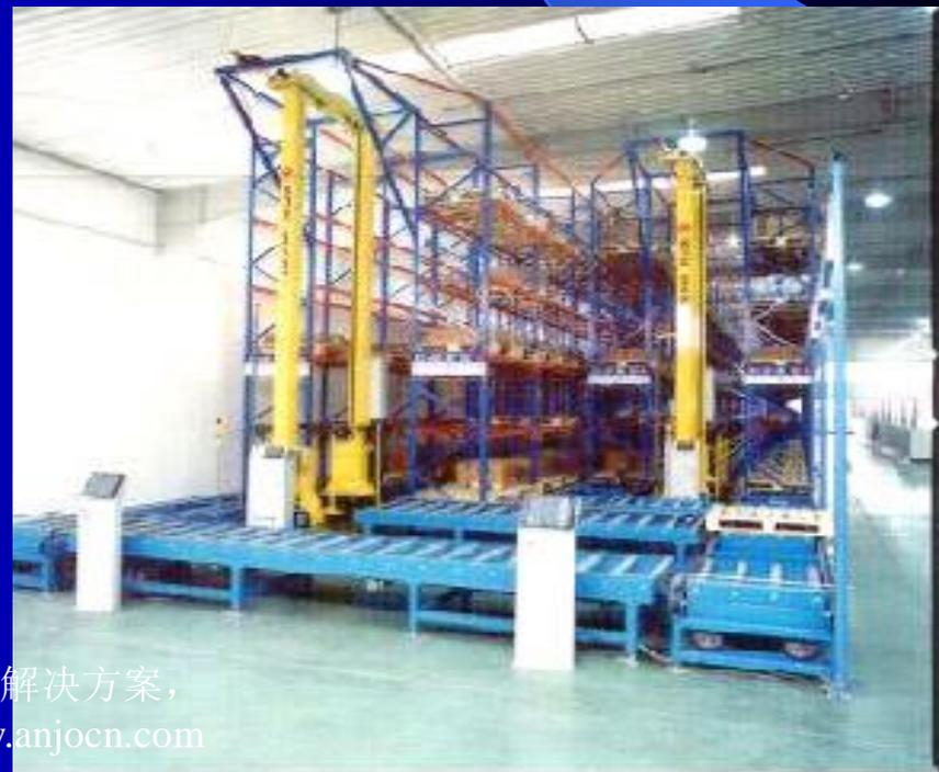
由于近来人工成本的不断提升，柔性化制造系统 (Flexible Manufacturing System) 的兴起，有更多的工厂对立体化自动化仓库兴建意愿和兴趣愈加浓厚，加上科技与计算机技术的进步，已达到仓库无人化的境界。自动化立体仓库不仅取代了人力和烦琐的人员登录作业，更达到迅速、正确传送物品和信息的功能。
