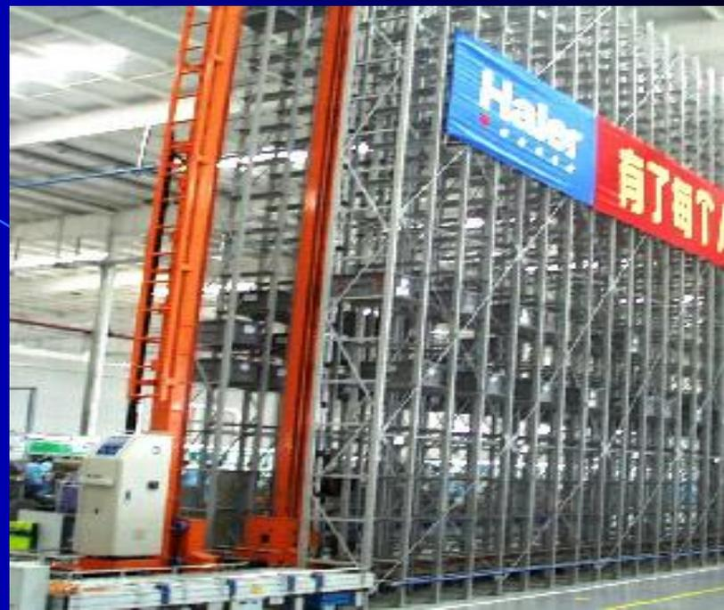
立体仓库具有多种型式，但基本上均是由用以收藏工作物、工具托板等“物”的货架或整列贮存装置及用以将它们(指工作物或工具托板等物)搬入或搬出的机器所构成的。4
